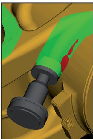
Un nuovo utensile per lucidatura utilizza due forme per rappresentare la superficie di lucidatura, con un limite interno ed uno esterno. Si colora la superficie del pezzo lavorato dall'utensile di lucidatura. Viene segnalato un errore se il limite interno entra in contatto con il pezzo.
